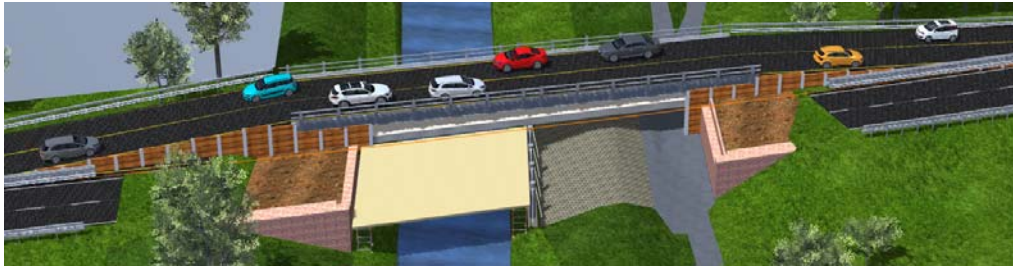
Abbildung 7: Bauphase 1, Verkehr auf Hilfsbrücke
